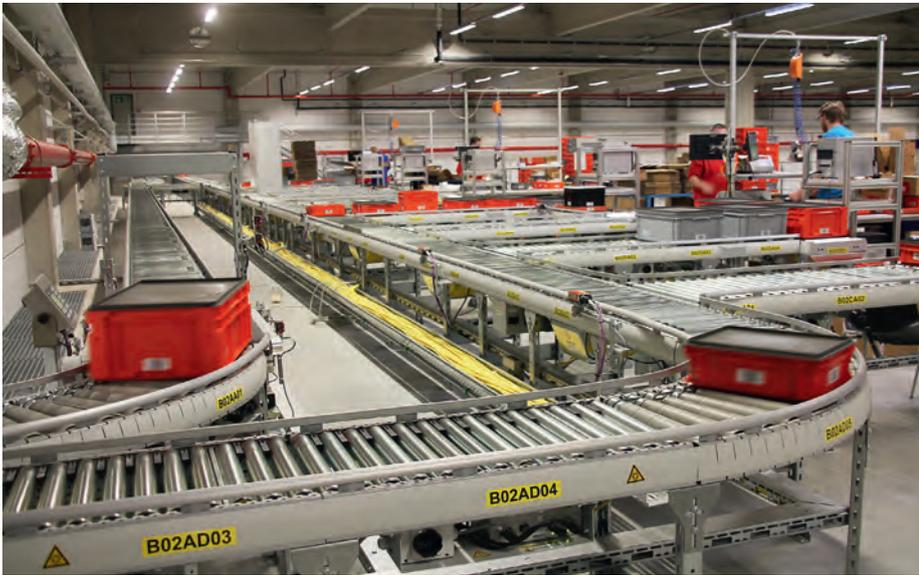
Über die Behälterfördertechnik kann die Ware in die Vorzone des Shuttlelagers im Obergeschoss befördert werden.
