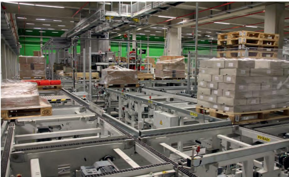
Die Palettenförderertechnik verbindet den Wareneingang mit dem HRL und der Kommissionierung.
