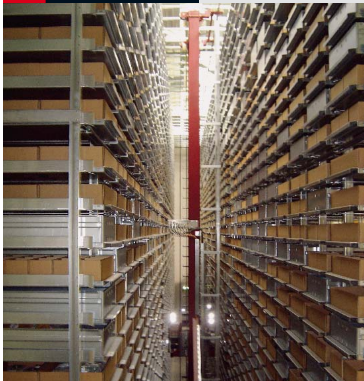
Im neuen Ersatzteillager von Polar: Als Generalunternehmer lieferte Westfalia auch das Regalfahrzeug (Foto). Seine Fahrgeschwindigkeit beträgt 240 m/min, seine Hubgeschwindigkeit 120 m/min.
