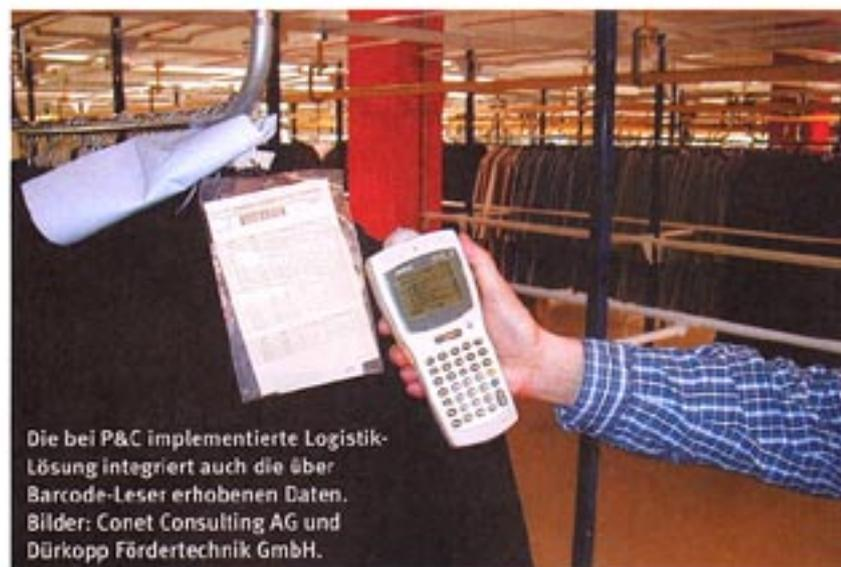
Die bei P&C implementierte Logistik-Lösung integriert auch die über Barcode-Leser erhobenen Daten. Bilder: Conet Consulting AG und Dürkopp Fördertechnik GmbH.
