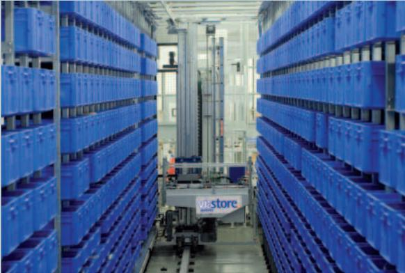
Das AKL dient als Lager und Sorter. Es wird von einem RBG des Typs viaspeed versorgt.
