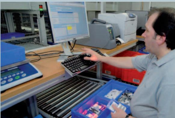
Lichtpositionieranzeigen helfen beim Kommissionieren. Das erhöht die Effizienz.
