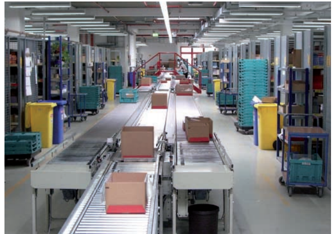
Die umfangreiche Behälterfördertechnik ist zentrales Element der Kommissionierung.
