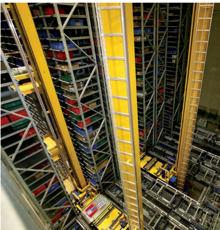
Blick in das automatische Kleinteilelager. Als Ladungsträger werden Tablare eingesetzt, die Behälter und Kartons tragen.
