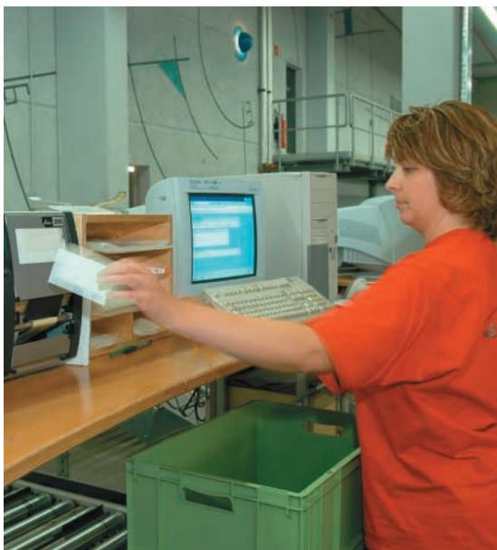
An insgesamt sechs Kommissionierarbeitsplätzen (3 HRL, 3 AKL) wird nach dem Pick-Ët-Pack-Prinzip gearbeitet. Unterstützung bieten Pick-to-light-Anzeigen. (Bild rechts)
