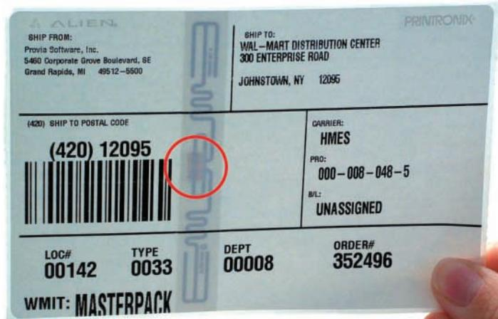
schieht über das Aussenden von Funksignalen, so dass die auf dem Tag gespeicherten Informationen ohne Sichtkontakt über ein tragbares Gerät gelesen, verarbeitet und geändert werden können. In der RFID-Technologie wird der zukünftige Nachfolger des klassischen Barcodes gesehen.
