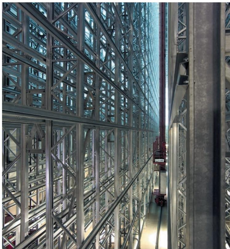
In der Hochregallageranlage von BASF Coatings AG werden 11 Regalbediengeräte des Typs viapal eingesetzt.
