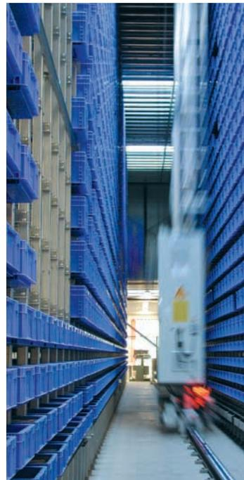
Höhere Logistik-Leistung mit automatischem Kleinteilelager bei RK Rose+Krieger in Minden.
