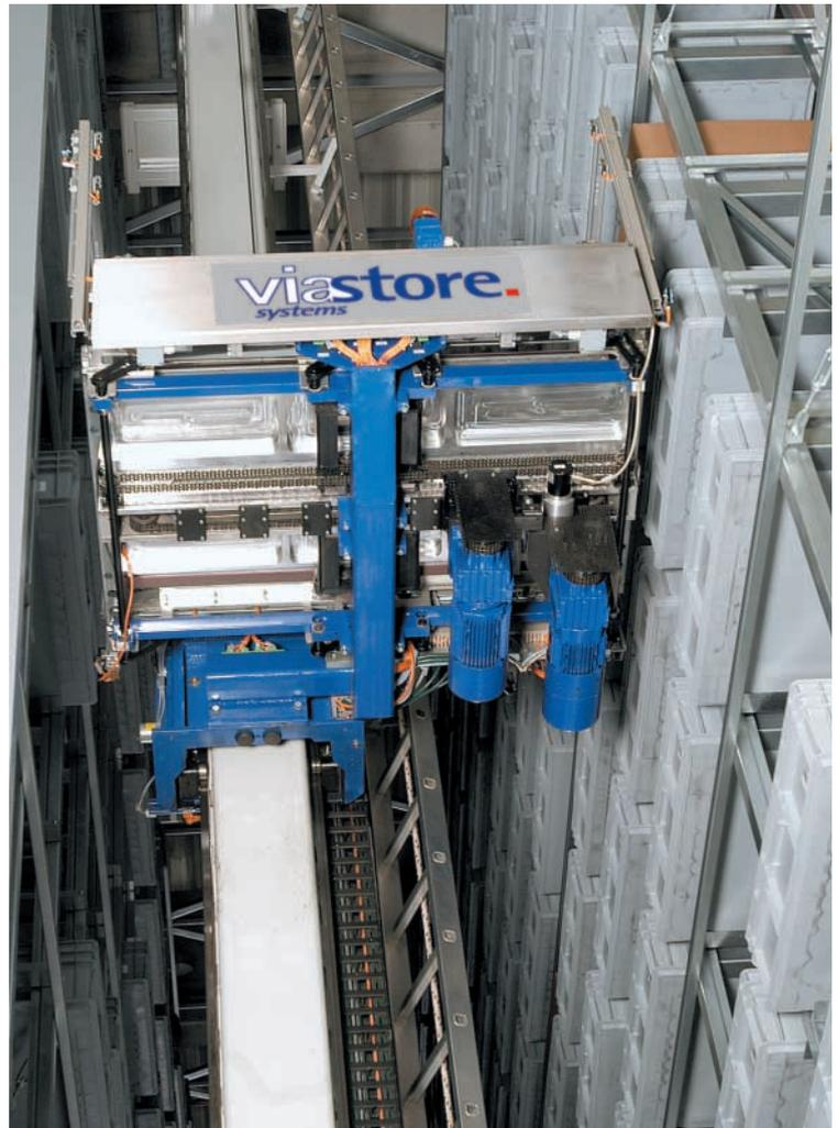
Im AKL sorgen Regalbediengeräte des Typs viaspeed für die schnelle und effiziente Ein- und Auslagerung der hochwertigen Handelsware.
