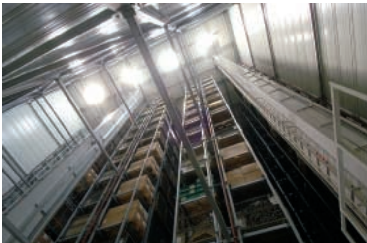
Das HRL bietet Platz für mehr als 6.600 Europaletten oder Gitterboxen in vier Gassen. Derzeit kommt Mekra Lang noch mit 5.000 Plätzen in drei Gassen aus.
