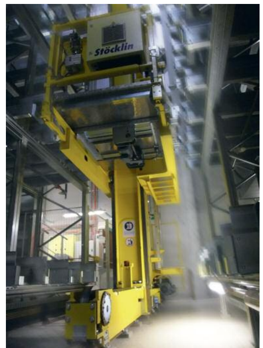
Ein-Mast-Regalbediengerät Master 24 mit Hebebühne für automatisches Kanalfahrzeug
