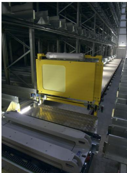
Automatisch gesteuertes Kanalfahrzeug für die Einlagerung von Paletten in Längsrichtung
