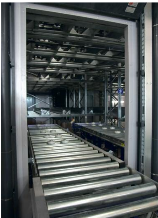
Ein- und Auslagerbahnen für Paletten im Kanallager bei der CSL Behring AG, Bern
