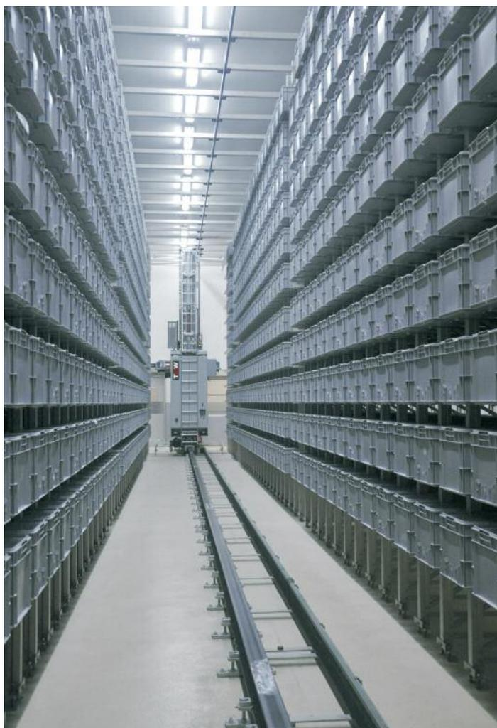
Im Reifungspuffer in Form eines automatischen Kleinteil-lagers ‚reifen‘ die Eiswaffeln unter der Aufsicht eines Timers
