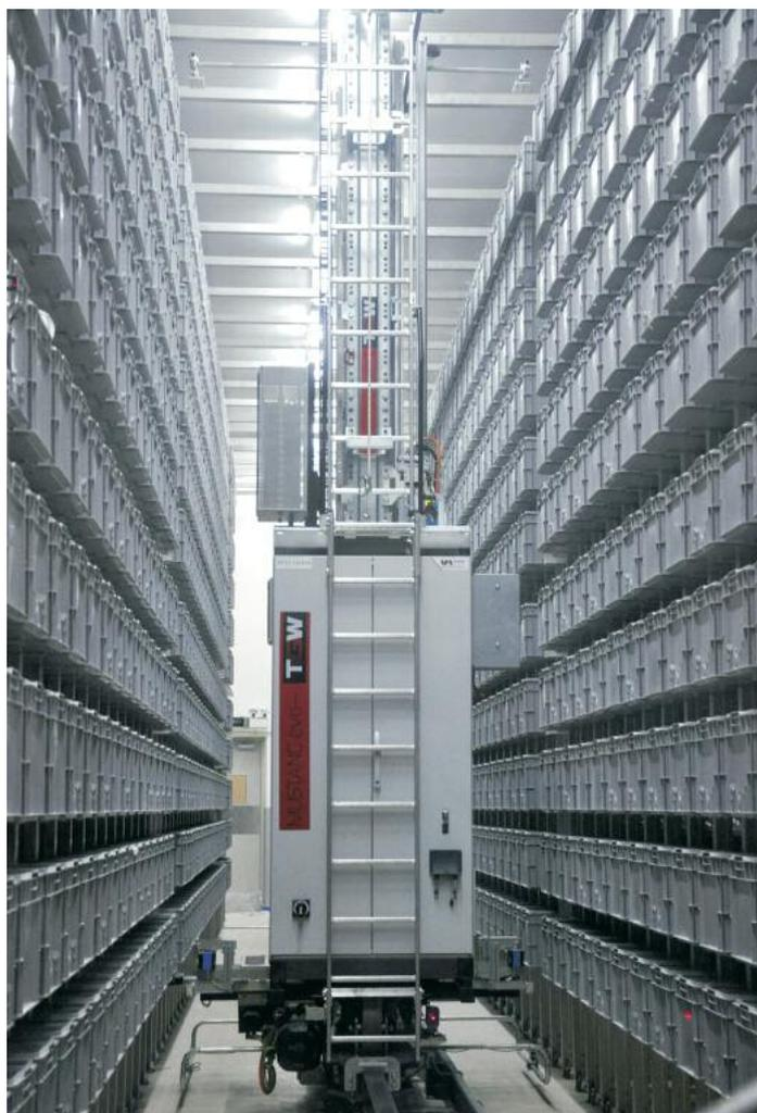
Sind die Eiswaffeln ‚reif‘, werden die Behälter automatisch mit einem Regalbediengerät ‚Mustang Evolution‘ ausgelagert
