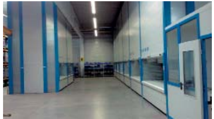
Die in das WMS Prolag®World eingebunden Shuttles stehen sich in zwei Reihen gegenüber
