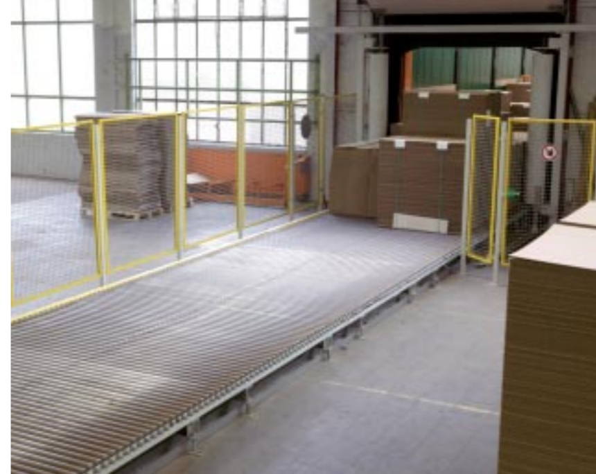
Zonder dat er een mens aan te pas komt, schuift de complete lading bij KappaRapidCorr in 90 seconden de vrachtauto in
