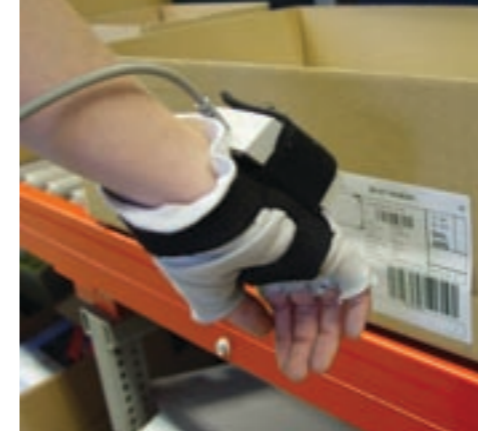
De orderpickers van Corporate Express beschikken over zowel een headset als een polsscanner. Het picken start pas als de barcode op de doos is gescand
