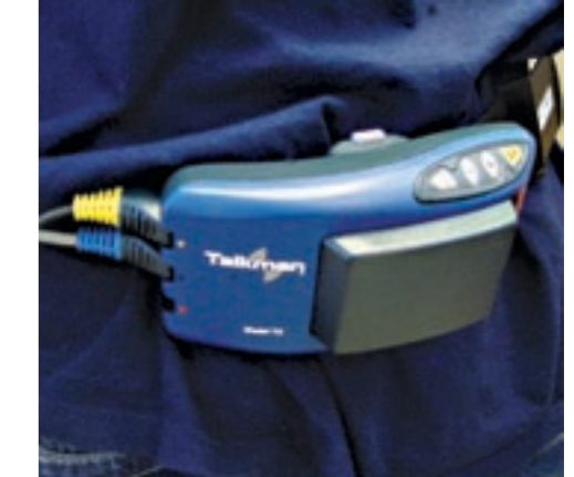
De hardware is afkomstig van Vocollect en biedt naast een aansluiting voor de headset ook een aansluiting voor de polsscanner
