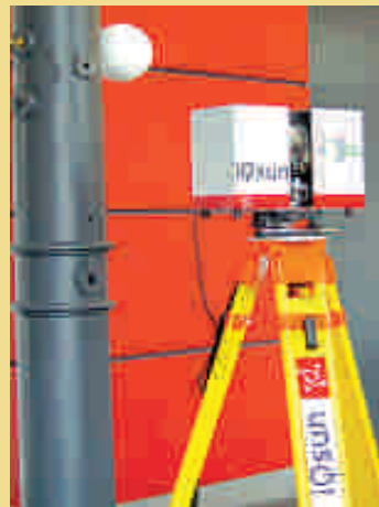
De scanner bestaat uit een laser die via een snel roterende spiegel de omgeving afast
