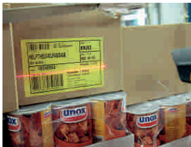
Elke rolcontainer die in Eindhoven moet worden gecrossdockt, heeft een unieke barcode die is gekoppeld aan informatie over de inhoud en de bestemming
