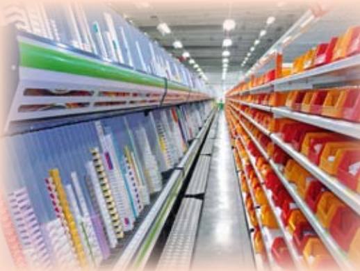
Highlight van het nieuwe logistieke centrum vormen de drie orderverzamellijnen met A-frame orderverzamelautomaten met in totaal 6.264 kanalen voor het orderverzamelen
