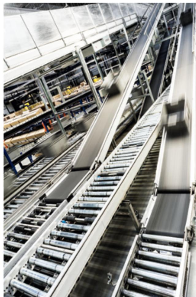
*Im LPP-Logistikzentrum unterstützen mehrere Kilometer automatischer Förderer mit integrierten Scannern und Wiegesystemen sowie vier Sorter mit insgesamt 1.200 Zielstellen die automatisierten Prozesse.*
