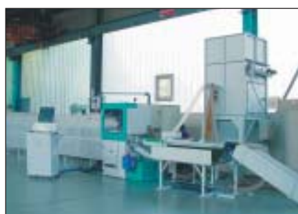
Bimax TA 90 CNC mit Beschriftung der Teile und mit Späneabsaugung und Auslaufband.
