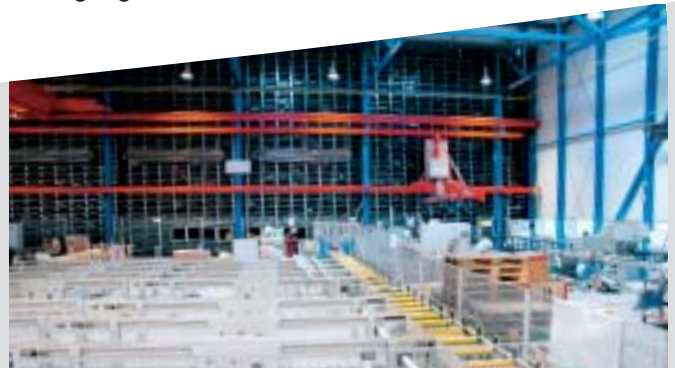
KASTO-Wabenlager für Langgut, 4434 Plätze
